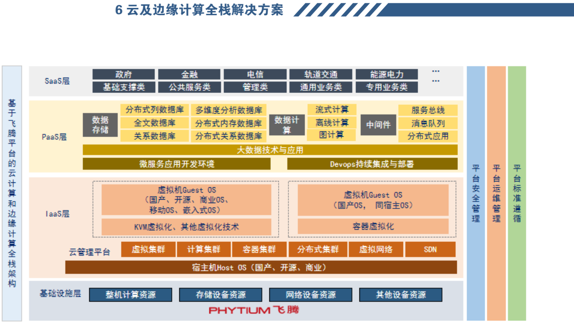
图 13 基于飞腾平台的云计算和边缘计算全栈架构图
