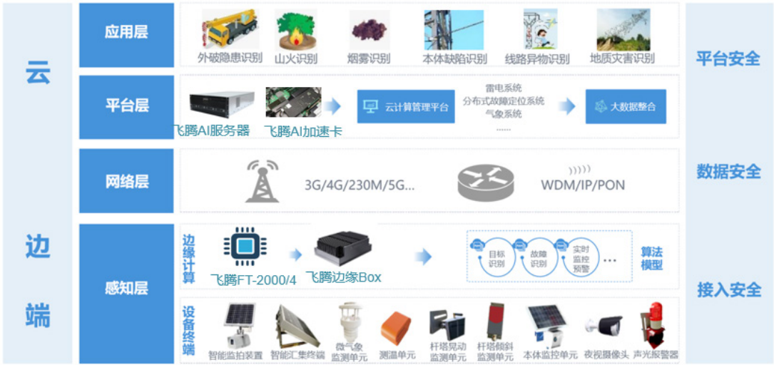
图 45 输电巡检场景的 AI 解决方案架构
