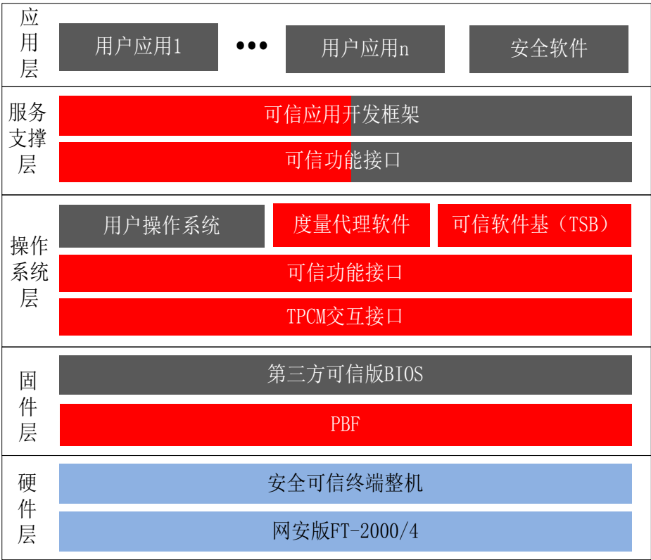
图 30 TPCM 可信计算终端系统架构图
